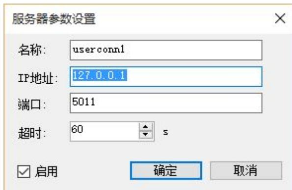
设置用户侧软件的 TCP 服务通讯端口，通讯建立后组态软件根据超时设置判断通讯异常，因此用户侧软件必须保证在超时时间到达前提供数据。
